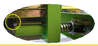
リミットスイッチにより台車を安全に停止させます
